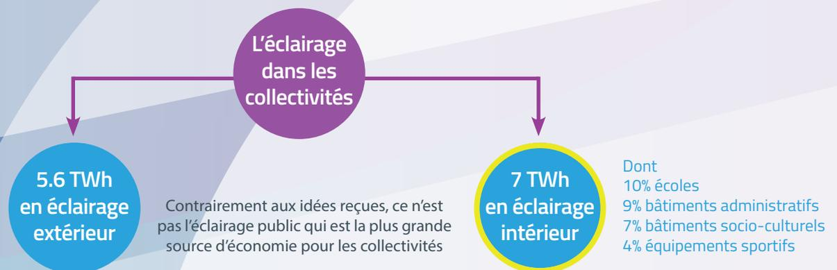
■ **Source d'économie d'énergie** : la rénovation des éclairages en LED peut permettre jusqu'à 60% d'économies d'énergie sur l'électricité pour un retour sur investissement relativement faible (minimum de 3 ans – variable selon les situations) et jusqu'à plus de 75% avec une gestion appropriée de l'éclairage.
